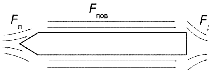
Рис. 1. Исследуемый объект, его обтекание потоками воды и силы, которые действуют при горизонтальном движении.
